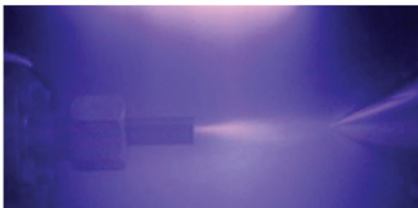
Рис. 2. Визуализация потока газа из сверхзвукового сопла с помощью газового разряда
